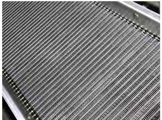
Der Transportgurt ist durch seine beidseitigen Schleppketten mit einem Querstabdrahtgurt extrem robust und langlebig.
